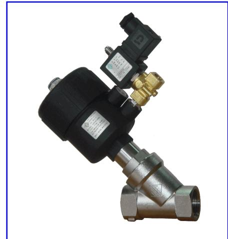
При подаче напряжения на катушку нормально закрытого 3/2 ходового управляющего электромагнитного клапана, его плунжер открывает порт **A** и закрывает порт **C**. Направление движения управляющей среды: **A** → **Б**. Управляющая среда через порт **Б** попадает под поршень пневмо(гидро)привода и, преодолевая усилие пружин, перемещает его. Клапан открыт.
